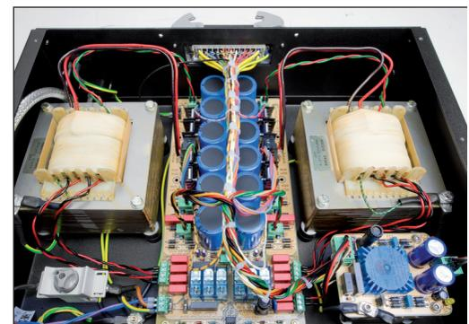
*Das Netzteil des Emitter 1 ist von der außerordentlich leistungsfähigen Sorte. Zwei große Trafos befeuern den Verstärker kanalgetrennt*
