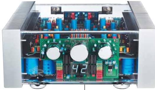
spiegelsymmetrisch angeordnet und besitzen mit einer Phalanx vorgeschalteter Elkos auf der unteren Platine weitere, bordeigene Speicher für flotteste und konstanteste Versorgung. Über die einwandfreie Funktion des Ganzen wacht ständig ein Mikroprozessor, als weitere Sicherheitsorgane fungieren Schutzschaltungen gegen Überlast, Übersteuerung, Kurzschluss, Übertemperatur oder Gleichspannung - eventuelle Störungen werden auch prompt angezeigt.
