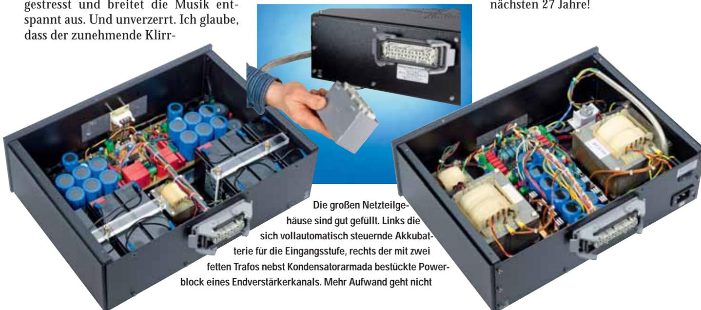
Die großen Netzteilgehäuse sind gut gefüllt. Links die sich vollautomatisch steuernde Akkubatterie für die Eingangsstufe, rechts der mit zwei fetten Trafos nebst Kondensatorarmada bestückte Powerblock eines Endverstärkerkanals. Mehr Aufwand geht nicht
